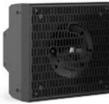
Dragon-KX12 Тип: коаксиальная Динамики: 12" + 2.4" Диапазон частот: 120 Гц – 19 кГц Макс. SPL: 133 дБ (пик) Мощность: 1200 Вт Угол раскрытия: 30°/100° × 100°/30° Разъемы: 2 × Speakon NL4 Ном. сопротивление: 8 Ом Размеры: 340×320×201 мм Вес: 12,2 кг Материал корпуса: нержавеющая сталь Цвет: черный, индивидуальный Степень защиты: IP21
